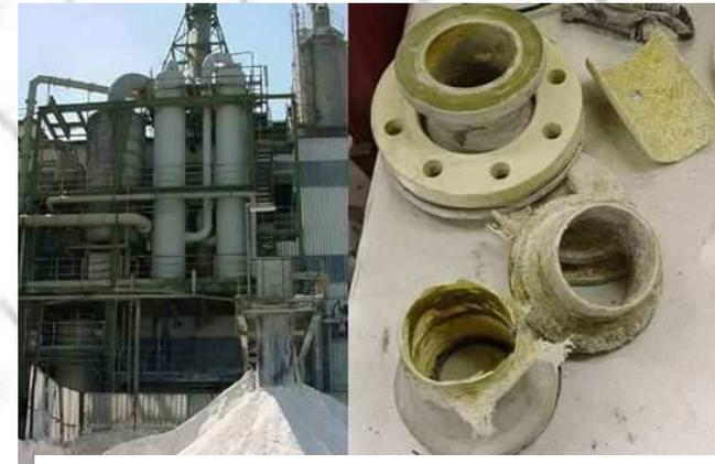
⊙ Zerstörung eines Abgaswäschers an holländ. Phosphoranlage durch Projektierungsfehler
