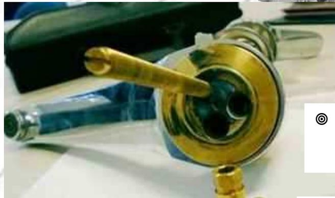
⊙ Korrosionsbruch an Wasserarmatur, Verdacht auf Manipulation
